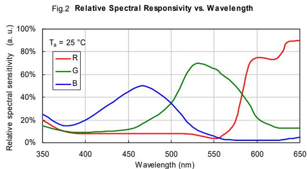
TYPICAL ELECTRO - OPTICAL CHARACTERISTICS CURVES
